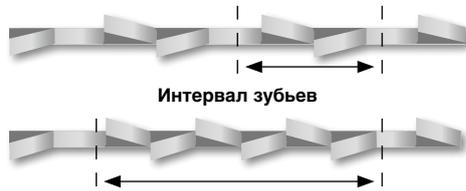
Универсально подходит для толщины реза от 5 мм для стали, литья и твердых цветных металлов. Постоянный шаг зубьев: последовательность разводки влево / вправо / прямо. Переменный шаг зубьев: на каждый интервал как минимум один зуб не разведен, разводка остальных зубьев в интервале повторяется влево / вправо или в обратной последовательности.
