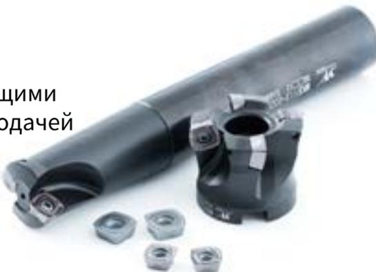
Серии сменного фрезерного инструмента
