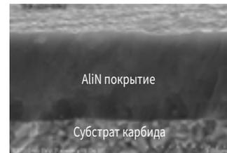
Фотография покрытия с помощью РЭМ (СЭМ)
